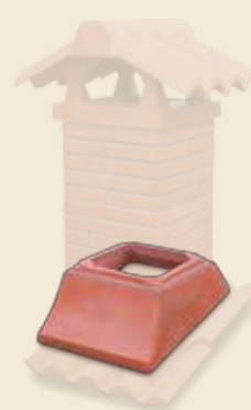
Raccordo modulare canna regolabile in base alla pendenza (fissare "in malta" dopo la regolazione) Dim. 50 x 63 x H 27 cm 33 x 33 cm (interno canna) Peso 37 kg
