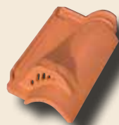
171F01 Tegola per aerazione Prevedere l'utilizzo di un aeratore ogni 25 mq di tetto
